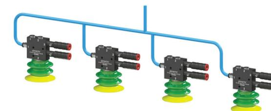
Децентрализованная система сконструирована таким образом, что каждая присоска имеет специальный генератор вакуума. Это означает, что все присоски независимы друг от друга; такая система, как правило, используется для манипуляций с объектами с пористыми поверхностями.
