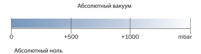
На схеме показана взаимосвязь между абсолютным, относительным и отрицательным давлением. Из схемы видно, что могут произойти серьезные ошибки, если не указан тип давления. Значение 40 кПа может указывать на три различные ситуации.
